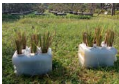
Vetiver trong nước nhiễm kim loại nặng đậm đặc được lấy từ Khu Công nghiệp Điện Nam - Điện Ngọc nhưng vẫn phát triển tốt sau 18 ngày. Vetiver in strong heavy metals polluted water but still grow well after 18 days
